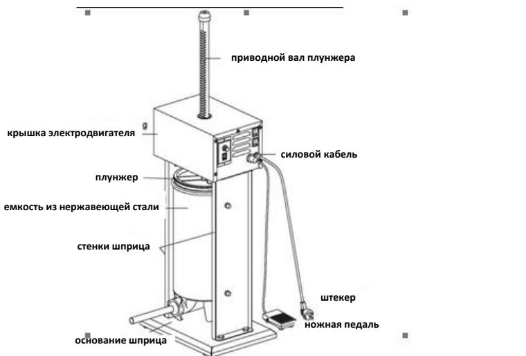
регулировка скорости по часовой стрелке: ускорение против часовой стрелки : замедление остановка
