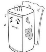
Schlechte Wärmeableitung, prüfen Sie, ob um das Gerät herum ausreichend Platz für die Belüftung vorhanden ist.
