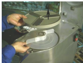
Instalación de lámina para cortar (4)
