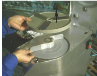
Installation der Schneidescheibe (4)
