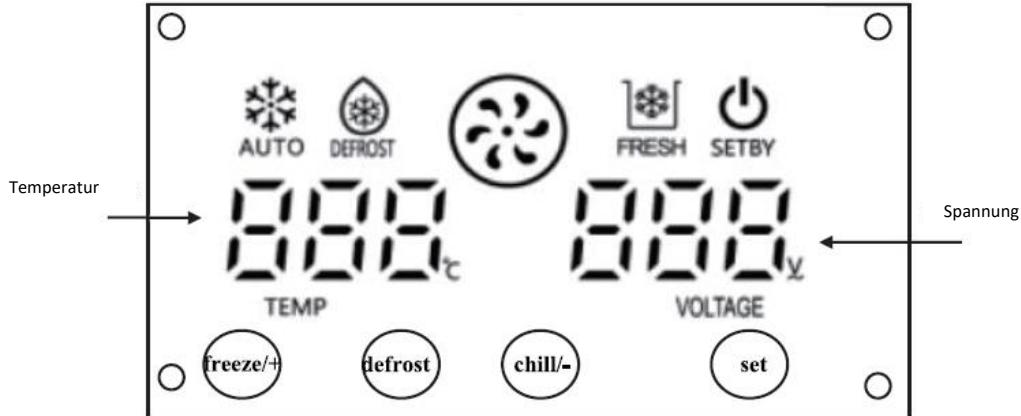
5.1 Bei der Einschaltung des Gerätes leuchtet die Anzeige **SETBY** auf. Die linke Seite des Displays zeigt die Temperatur, die rechte Seite die Spannung an.
