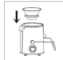
3. Verschließen Sie die Schale mit dem Deckel (3), so dass sich die Entleerungsöffnung des Deckels über dem Abfallbehälter befindet.
