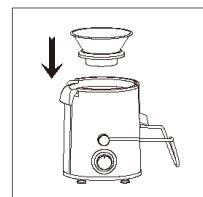
3. Chiudere la vaschetta con il coperchio (3) in modo che l'apertura di scarico sul coperchio stia sopra il contenitore per rifiuti.
