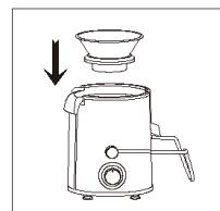
3. Fermez le bol avec le couvercle (3) de sorte que l'orifice de décharge du couvercle soit au-dessus du récipient à déchets.
