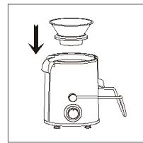
3. Cierre la cubeta con la tapa (3) de forma que la abertura de descarga de la tapa quede por encima del contenedor de residuos.
