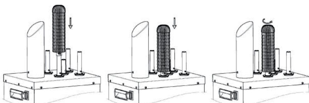
Установите стержень для щёток на основание приводного вала, поверните против часовой стрелки, чтобы перпендикулярный шпенёк на приводном валу вошёл в выемку на ручке щётки. (Совет: короткую щётку надевают на центральный стержень).
