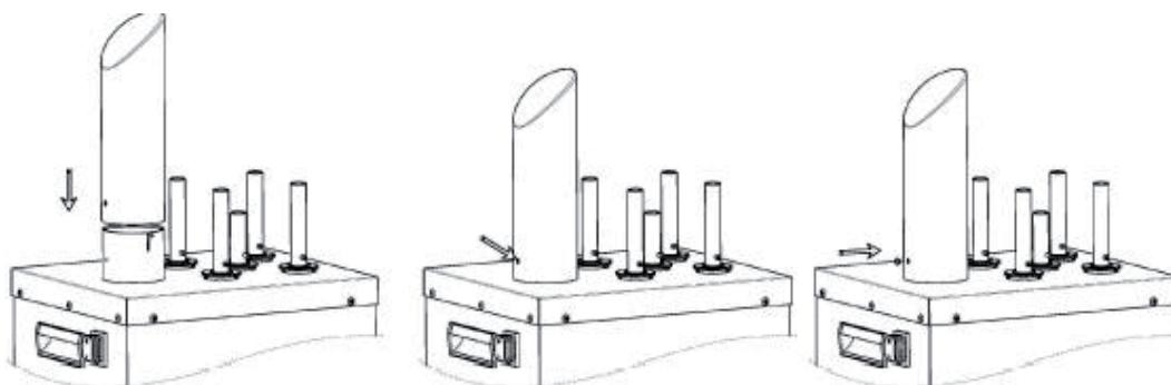
Установите нагнетатель на основание трубы для нагретого воздуха, отрегулируйте направление, вращая его, выровняйте овальное отверстие нагнетателя по отверстию для винта на трубе подачи горячего воздуха и затяните винты.
